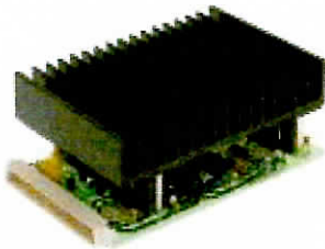
Figura N.º2 – Unidade de potência
